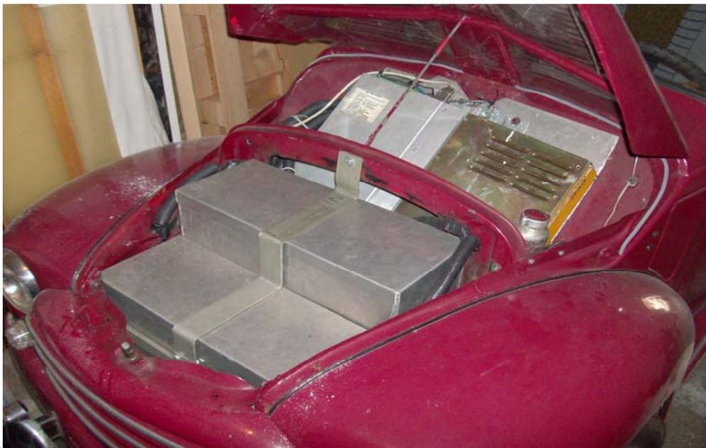
Im vorderen Kasten sind Block 4 und der halbe Block 5, im hinteren Kasten die andere Hälfte von Block 5 und Block 6 eingelegt.
