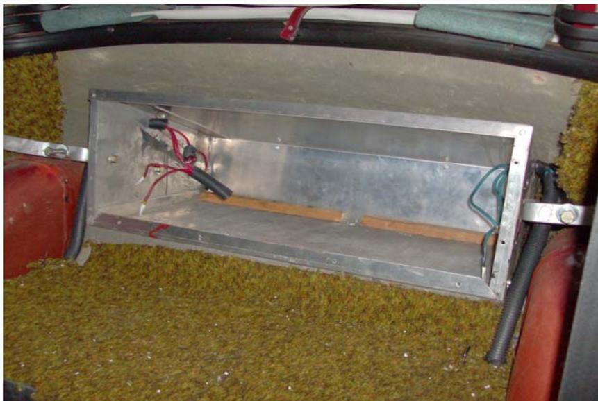
Auf der rechten Wagenseite sind die Anschlüsse für + (rote Kabel) und links für - (blaue Kabel) für 50 V geführt.
