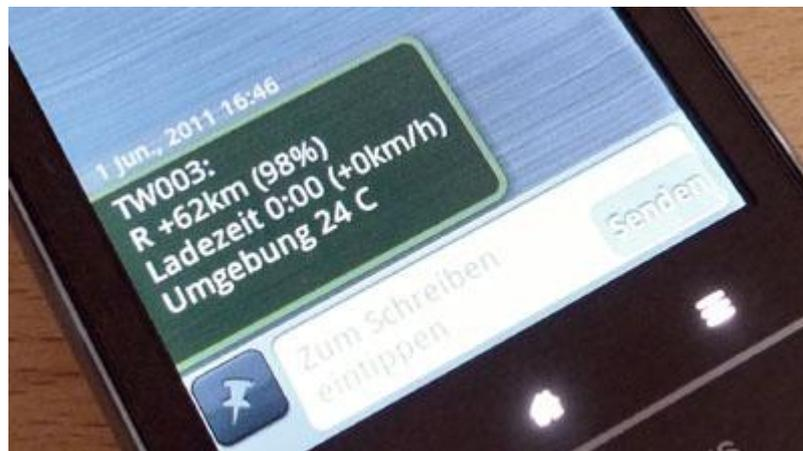
*Hinweis zur SMS-Funktion: Wenn die Netz-Verbindung des Modems gestört ist (z.B. in Tiefgaragen), dann steht der Dienst nicht zur Verfügung. Nach dem Einschalten des Fahrzeuges oder nach einem gesendeten SMS muss rund 2-3 Minuten gewartet werden, bis der Dienst wieder bereit ist. Für Fahrten ausserhalb der Schweiz sind die lokalen SMS-Roamingtarife zu beachten. (Weitere Informationen auf Anfrage.)*
