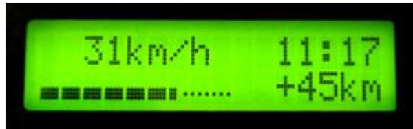
Mit der ENTER-Taste erreicht man eine alternative Anzeige, die ähnlich wie früher links oben die Geschwindigkeit, rechts oben die Tageskilometer, unten die Spannung, Strom und verbleibende Reichweite darstellt.
