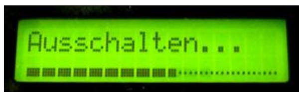
Wird das TWIKE länger als 10 Min nicht benutzt, so schaltet der dreifels Controller automatisch auf den Pausenmodus und danach komplett aus. Durch Eingabe der ersten 2 Zeichen des Zugangscodes kann es wieder eingeschaltet werden.
