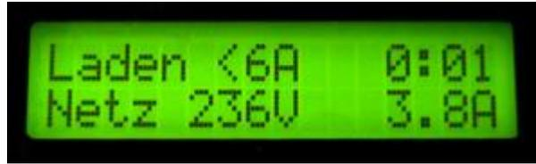
Im Beispiel betrug die Zeitdauer, wo ein nennenswerter Ladestrom floss 3:45 Stunden. Wenn sich das Twike nach der Ladung automatisch ausgeschaltet hat, kann dieser Wert überprüft werden, wenn man den Einschalt-Taster drückt, bevor (!) man das Ladekabel aus der Netzdose zieht.
